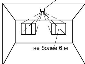
Рисунок 3 – Установка извещателя на потолке
