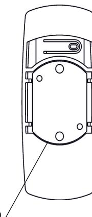
Рисунок 2 – Основание корпуса с печатной платой
